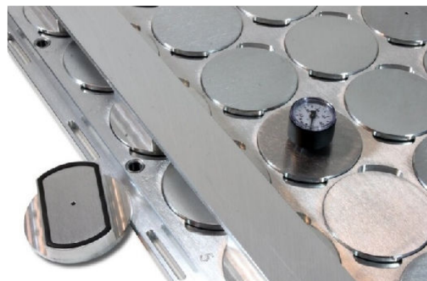
Ventouses pour largeur de pièces mini. de 46mm
