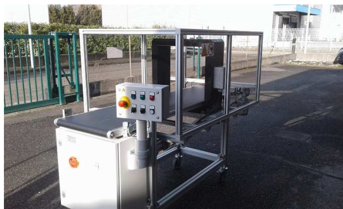
Exemple d'une machine, avec mise en place automatique des pièces dans le tunnel de démagnétisation pour le cycle de démagnétisation et retour des pièces en position initiale.
