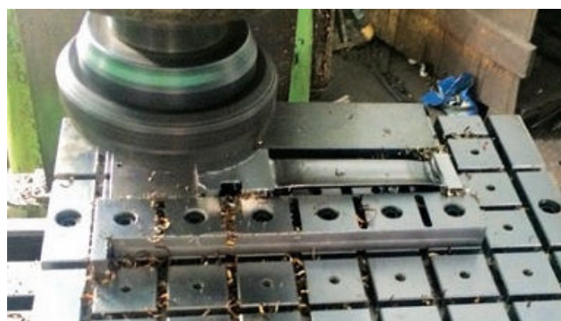
Usinage de pièces de turbine en acier inoxydable magnétique.
